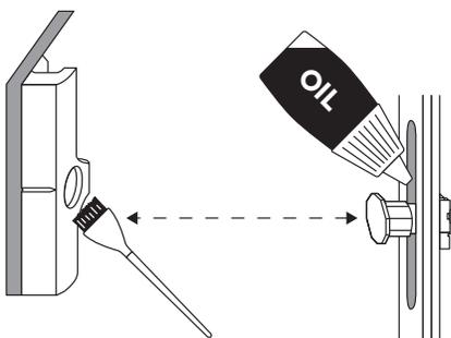
Um die Leichtgängigkeit zu erhalten, müssen die Schließbleche der Beschläge einmal jährlich an den Einlaufseiten mit Öl/Fett geschmiert werden.
