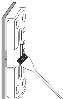
Die Gleitflächen der Schließbolzen sind mit Öl/Fett zu schmieren
