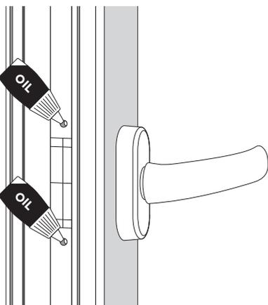
Das Beschlagsgetriebe muss einmal jährlich geölt werden.
